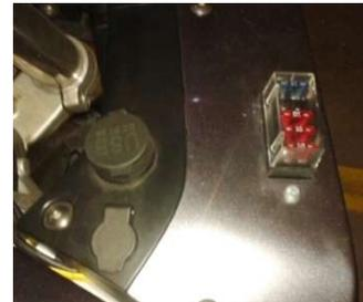
Der Sicherungskasten rechts enthält neben den beiden oben erwähnten Sicherungen noch diejenige für's Navi (10A ab Klemme 15), Griffheizung (10A ab Klemme 15) und eine weitere (15A ab Klemme 30) für das Ladegerät, das ich unter dem Fahrersitz eingebaut und fest verkabelt habe.
